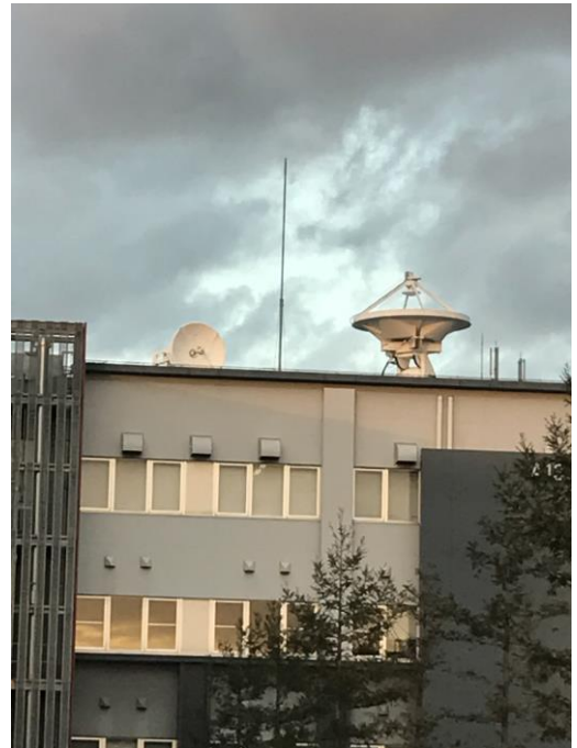
(図 5) 大阪府立大学サイエンス棟 (A13 棟) に設置された 3.8 m 電波望遠鏡 (右側)。左は実験用 1.8m 電波望遠鏡。
